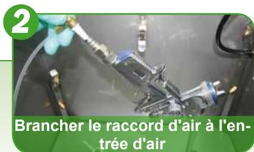
Avec les laveurs fermés de pistolets, toujours assurer la position correcte du pistolet dans la chambre de lavage. **Le liquide de nettoyage ne doit jamais pénétrer dans les canaux d'air du pistolet de laquage.**
